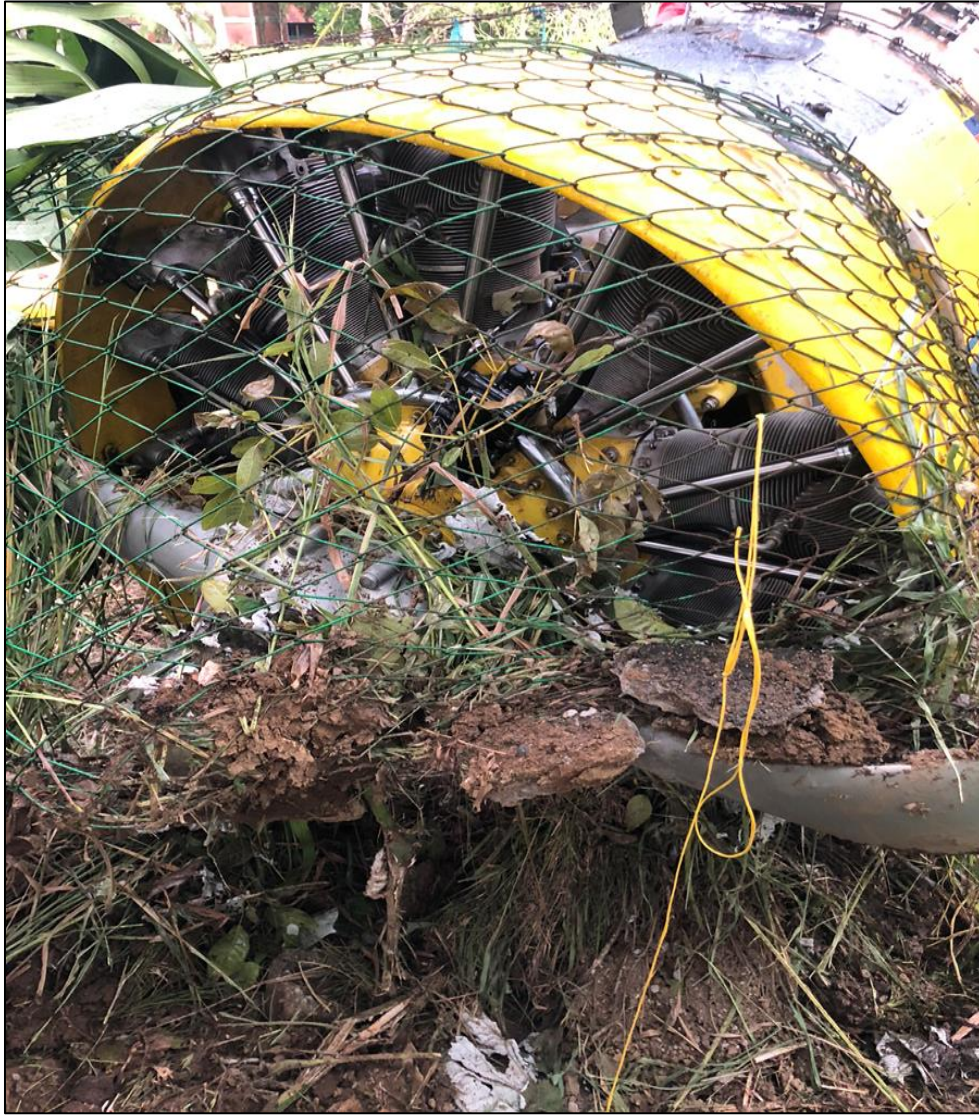
Fotografía No. 3: Malla que frenó y desvió la aeronave durante el aterrizaje de emergencia.
